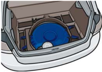
Der Flüssiggastank in der Reserveradmulde
