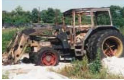
Defekte an Schläuchen und Leitungen (Kraftstoffleitungen, Hydraulikleitungen, Ölablaßschläuche), Isolierungsschäden an stromführenden Kabeln, heißgelaufene Lager, rutschende Keilriemen und vor allem die Entzündung von Verbackungen aus Staub, Spreu und Öl an heißen Motorteilen, hier insbesondere am Abgaskrümmner.
